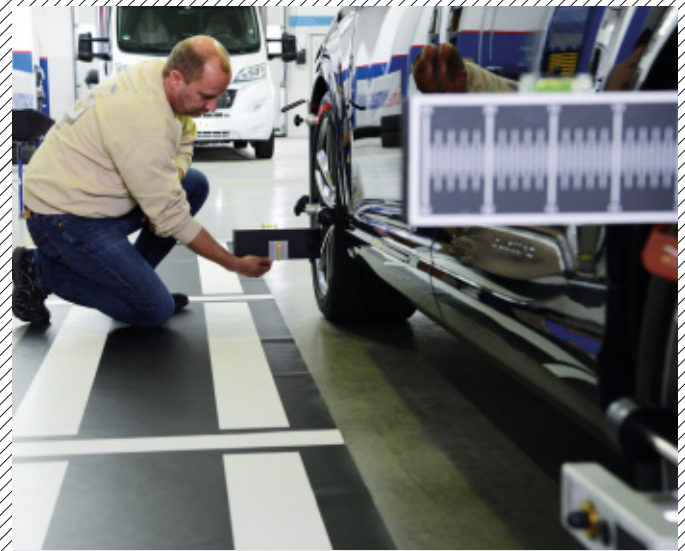
Spart  rger: Der Radaufnehmer Control erlaubt die schnelle Bewertung der Fahrzeugspur
