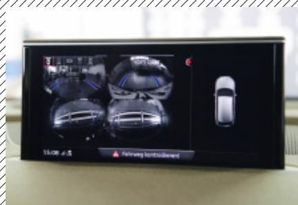
Die Kalibrierung der vier Kameras l sst sich auf dem Display mitverfolgen
