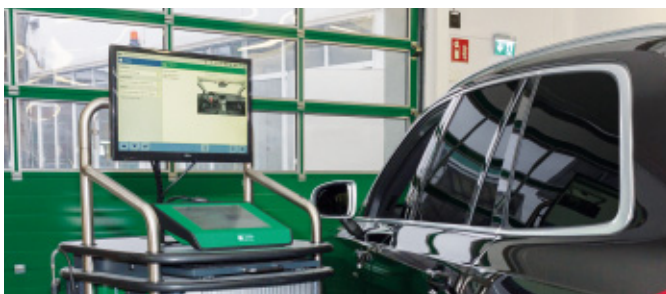
Der Datentransport aktueller Fahrzeuge wie des Volvo XC90 und der 2016er-Modelle des Audi A4 und BMW 5er erfolgt über DoIP
