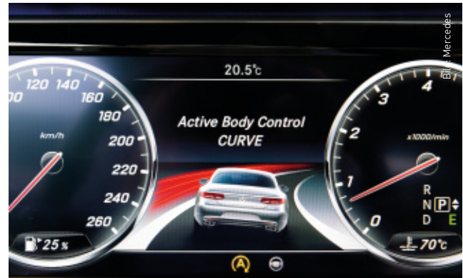
Noch komfortabler geht es kaum: Mercedes-Topmodelle mit Magic Body Control (MBC) legen sich im Modus „ABC Curve“ wie ein Motorradfahrer in die Kurve.
