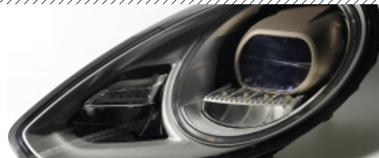
Der Prototyp des innovativen LCD-Scheinwerfers wird in realistischen Fahrsituationen von der Universität Paderborn getestet.
